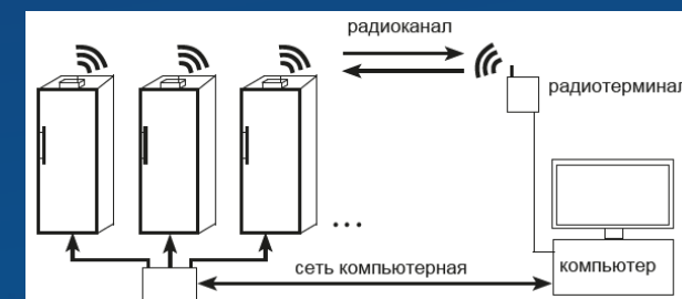
Структурная схема организации связи для системы мониторинга ММ-7205-001
