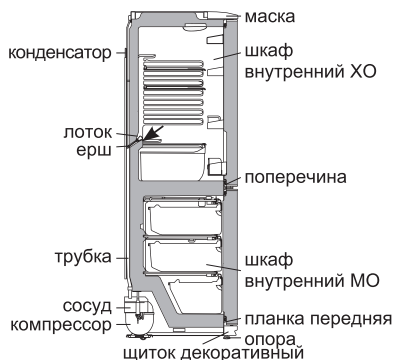
Рисунок 5 — Схема слива талой воды из ХО
